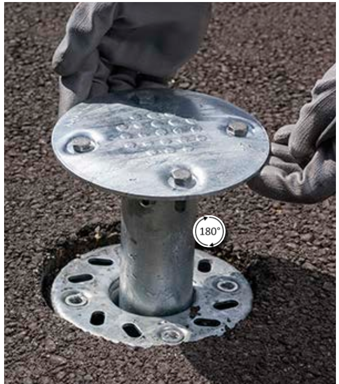
Käännettävä tolppa-ankkuri vautiluisteille ja mainostauluille: kun kampanja on ohi, käännä ankkuri ja kiristä ruuvit.
